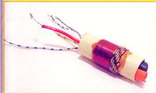
De antenne wordt aangesloten op de wit-zwarte draad.
